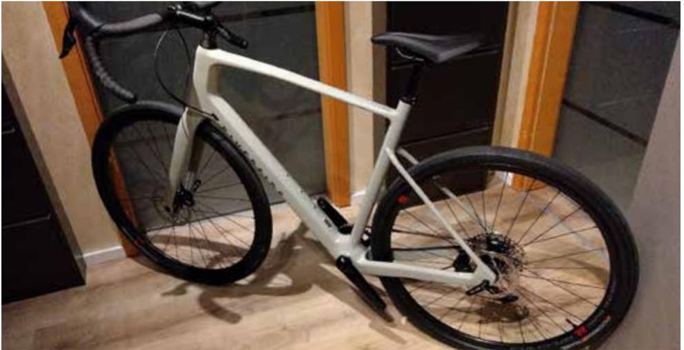
Crosser (Decathlon VAN RYSEL 8,9kg Größe L, 40mm Reifendurchlauf) und in derselben Preisklasse liegen Alu-Gravel anderer Hersteller dann mit 10 oder 10,5kg.
